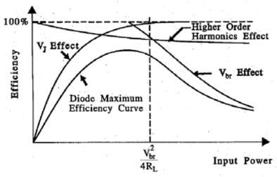
Fig. 2.3.17 Typical rectenna RF-DC conversion efficiency<sup>69</sup>
