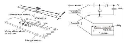
Fig. 3.6.2 μ-chip antenna<sup>38</sup>
